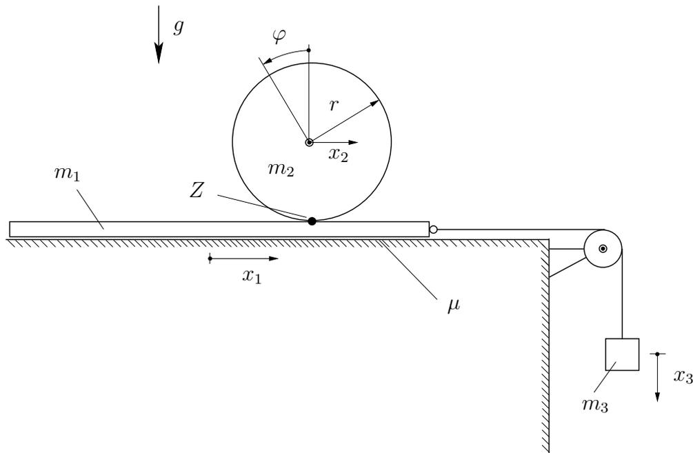
Ein Brett (Masse  $m_1$ ) ist über ein undehnbares Seil mit einem Gewicht (Masse  $m_3$ ) verbunden. Das Brett liegt auf einer rauen Unterlage (Reibkoeffizient  $\mu$ ) und das Seil wird über eine masselose Rolle umgelenkt. Auf dem Brett liegt im Punkt  $Z$  eine homogene Walze (Masse  $m$ , Radius  $r$ ). Das System wird aus dem Ruhezustand losgelassen. Es soll die Zeitspanne der Bewegung betrachtet werden bei der sich die Walze noch auf dem Brett befindet und gleitfrei abrollt.
