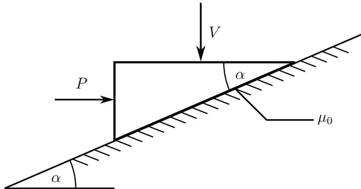
Ein starrer, gewichtsloser Keil liegt auf einer schrägen Ebene, die mit dem Winkel  $0 < \alpha < \frac{\pi}{2}$  gegen die Horizontale geneigt ist. Der Keil wird durch die gegebene Vertikalkraft  $V$  belastet und soll durch die horizontal angreifende Kraft  $P$  gegen eine Verschiebung gesichert werden. In der Kontaktfläche ist der Haftkoeffizient  $\mu_0$  anzunehmen.
