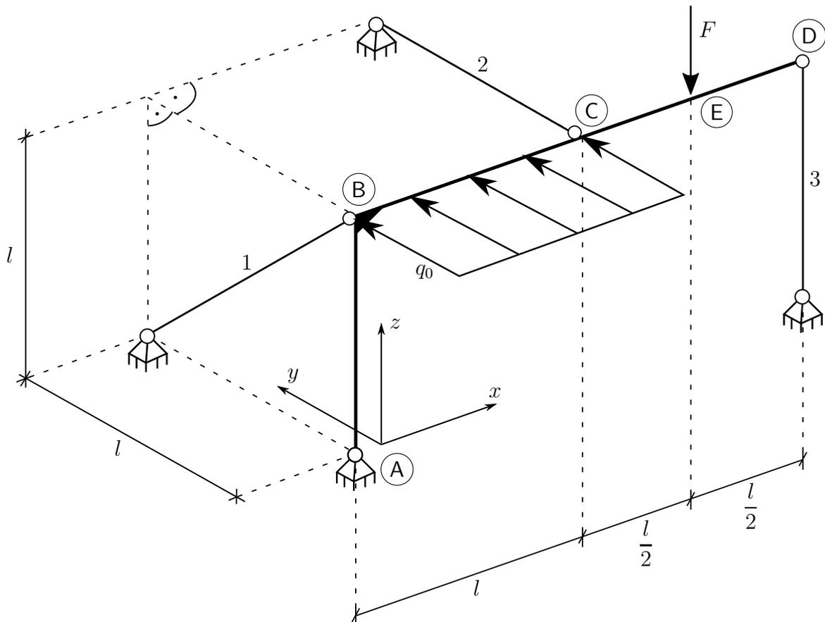
Ein rechtwinkliger, starrer Rahmen ABCD wird in (A) durch ein Festlager, in (B) durch den Stab 1, in (C) durch den Stab 2 und in (D) durch den Stab 3 gelagert. Er wird im Bereich BC durch die konstante Streckenlast  $q_0$  und in (E) durch die Kraft  $F$  belastet. Das System ist statisch bestimmt.
