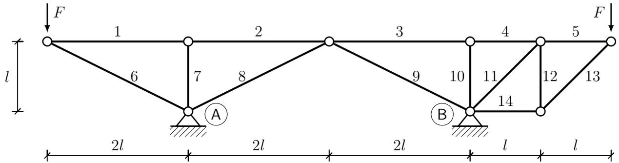
Das dargestellte, statisch bestimmte Tragwerk besteht aus 14 Stäben. Es wird in der abgebildeten Weise belastet. Bearbeiten Sie folgende Teilaufgaben:
