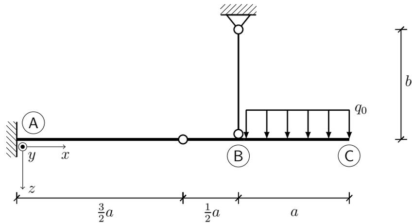
Gegeben ist das dargestellte Modell einer abgehängten Decke. Für das statisch bestimmte Tragwerk unter der Belastung einer konstanten Streckenlast  $q_0$  sind folgende Teilaufgaben zu bearbeiten:
