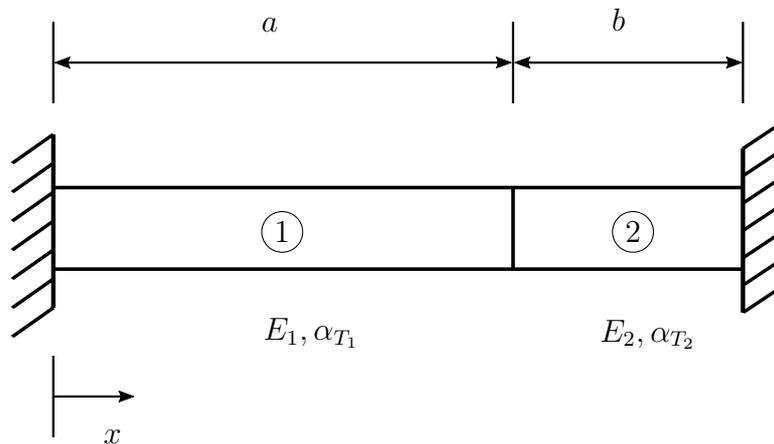
Ein Stab mit konstantem Querschnitt  $A$  ist wie skizziert im spannungsfreien Zustand zwischen zwei starren Wänden verbaut. Der Stab bestehe abschnittsweise aus unterschiedlichen Materialien ( $E_1, \alpha_{T_1}$  für  $0 \leq x < a$ ,  $E_2, \alpha_{T_2}$  für  $a \leq x \leq a + b$ ) und werde längs seiner gesamten Länge um die konstante Temperatur  $\Delta T$  erwärmt.
