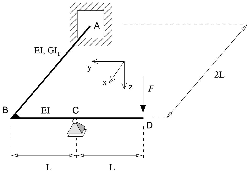
Das dargestellte räumliche Tragwerk wird im Punkt D durch eine Kraft  $F$  belastet. Bestimmen Sie die Auflagerkraft  $C$  im Punkt C sowie die Verschiebung des Punktes B in  $z$ -Richtung mit Hilfe des Prinzips der virtuellen Kräfte.
