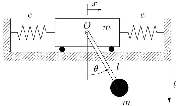
Ein Körper mit der Masse  $m$  bewegt sich ohne Reibung entlang einer horizontalen Fläche. Er ist über zwei Federn mit identischen Federsteifigkeiten  $c$  an starre Wände angeschlossen. Ein Pendel mit der gleichen Masse  $m$  und der Länge  $l$  ist im Punkt  $O$  drehbar befestigt. Das Pendel ist als Massenpunkt zu betrachten, der Pendelstab ist masselos.
